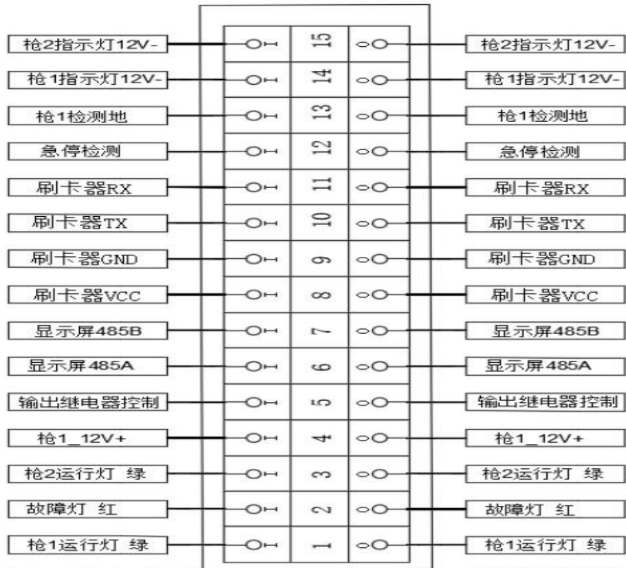
充电桩面板进线
